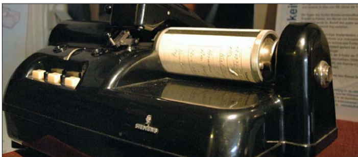
Mutter aller Faxgeräte: Das „KF (Kleinfax) 108“, ein etwa zwölf Kilogramm schweres Gerät mit Röhrentechnik, benötigte in den 50er Jahren rund drei bis vier Minuten zur Übertragung einer Papierseite. Fotos Kuhl
